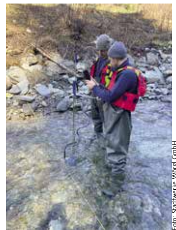
Mitarbeiter der Stadtwerke Wörgl beim Messen der behördlich vorgegebenen Restwasserabgabe.
